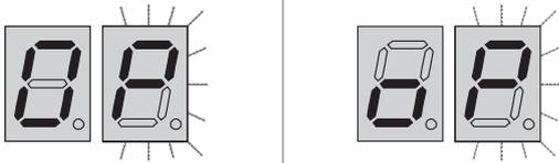
Tor ist gestoppt während des Öffnungsvorgangs: durch Gebrauch einer Fernbedienung oder eines Schlüsseltasters, infolge Funktion der Lichtschranken oder nach dem Stromausfall
