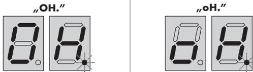
Tor ist mechanisch gestoppt während des Öffnungsvorgangs infolge des **dynamischen** Überlastschutzes
