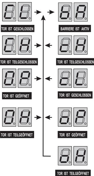
Bei aktiver Funktion der automatischen Schließung, revidiert die Lichtschanke ein Arbeitsbereich des Tores. Wenn während der Zeit, die zur automatischen Schließung übriggeblieben ist, ein Hindernis erkannt wird, wird die Zeit so verlängert, dass wenn ein Hindernis aus dem Arbeitsbereich geräumt wird, 6 Sekunden danach erfolgt die Schließung.
