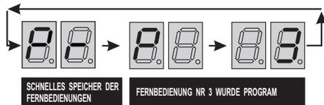
Diese Funktion wird automatisch verlassen 5 Sekunden nachdem die letzte Fernbedienung gespeichert wurde.
