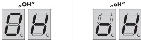
Tor ist mechanisch gestoppt während des Öffnungsvorgangs infolge des **statischen** Überlastschutzes
